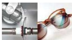
En su versión XD cuenta con Drill incorporado más potente con ángulo de perforado variable, lo que permite inclinar la perforación de forma manual o automática.
